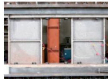
图18 矩形钢板阻尼器 [53]
